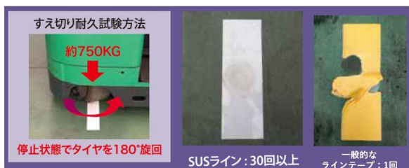
停止状態のリフトタイヤを旋回させる「すえ切り耐久試験」結果 一般的なラインテープとの比較
